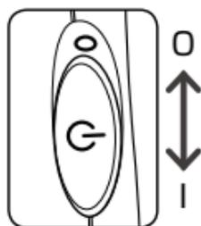
スイッチを「0」の方向へずらすと「ON」、「1」の方向へずらすと「OFF」
